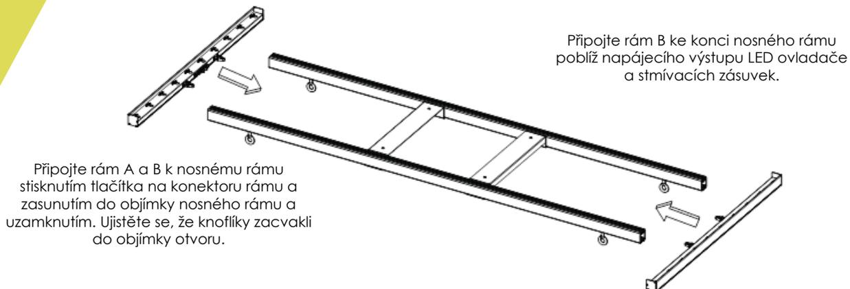
Při instalaci berte v potaz směr; když je zařízení zavěšeno, je montážní držák LED nahoře.
