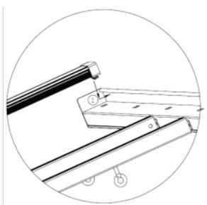
Ujistěte se, že je ovladač zajištěn, a otočte svítidlo tak, takže je ovladač nyní pod ním. Vložte konec světelné lišty s háčkem do čtvercového otvoru v rámu A.
