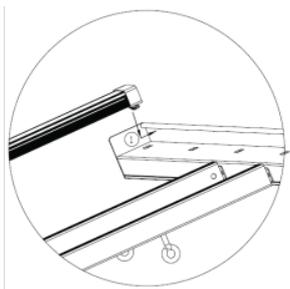
Assurez-vous que le transformateur soit bien sécurisé et retournez la lampe afin que celui-ci se trouve en dessous. Insérez le bout de la barre lumineuse avec le crochet dans le trou carré du support A
