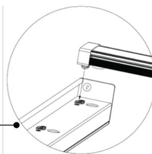
Luego inserte el otro extremo; alinear el agujero redondo en el Marco B con el extremo magnético de la barra de luz e inserte el pin macho en el enchufe hembra. Asegúrese de que la conexión magnética sea segura.
