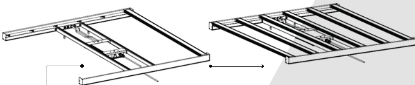
Assemblare il resto delle barre luminose nel telaio di fissaggio come mostrato in Figura
