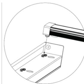
l'altra estremità; allineare il foro rotondo del telaio B con l'estremità magnetico della barra luminosa e inserire il perno maschio nella presa femmina. Assicurarsi che il collegamento magnetico sia sicuro.
