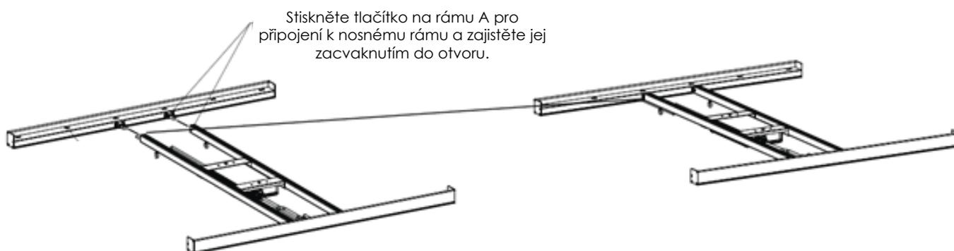
Při instalaci si všimněte směru; při zavěšení svítidla je přihrádka na řidič nahoře.
