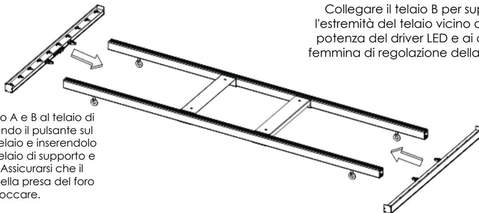
Collegare il telaio B per supportare l'estremità del telaio vicino all'uscita di potenza del driver LED e ai connettori femmina di regolazione della luminosità.
