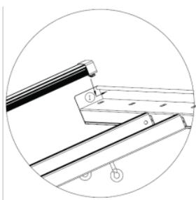
Vergewissern Sie sich, dass der Treiber befestigt ist, und drehen Sie die Vorrichtung um, so dass sich der Treiber nun darunter befindet. Stecken Sie das Ende des Lichtbalkens mit dem Haken in das Quadratloch im Rahmen A.
