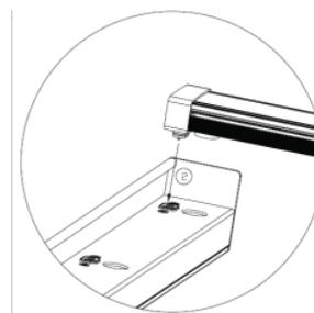
Dann das andere Ende einsetzen; das runde Loch am Rahmen B mit dem magnetischen Ende des Lichtbalkens ausrichten und den Stift in die Buchse stecken. Vergewissern Sie sich, dass die Magnetverbindung sicher ist.
