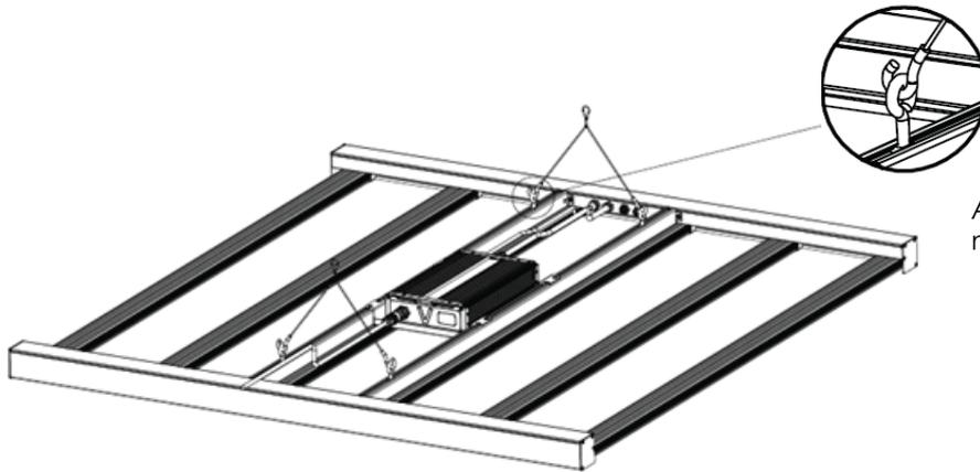
Attachez les câbles d'attache en métal aux crochets de montage.
