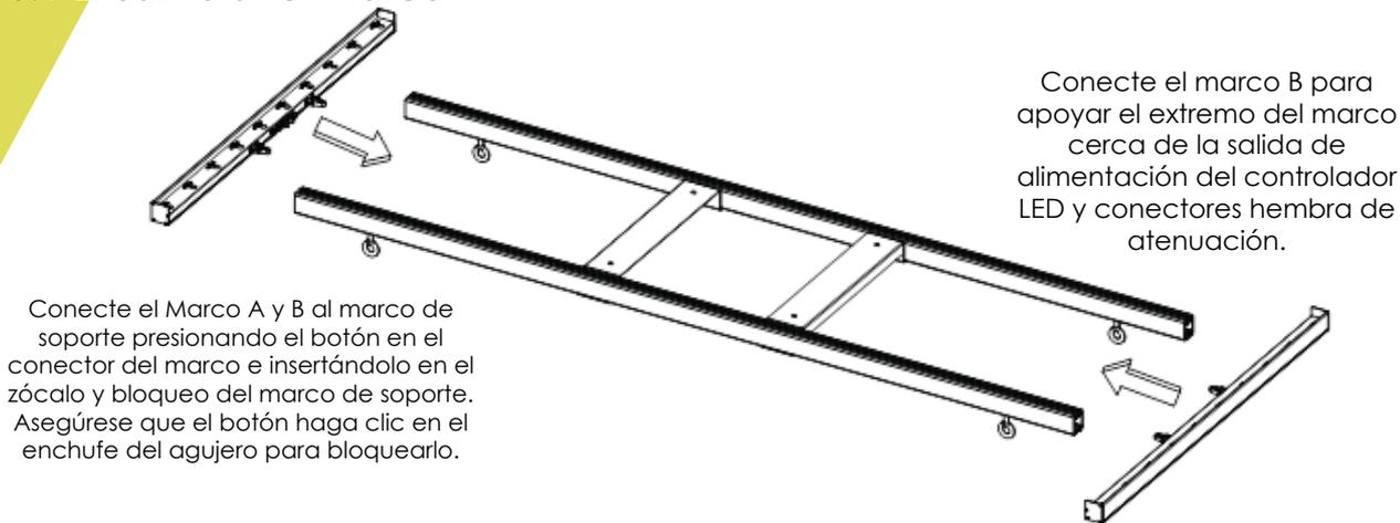
Conecte el Marco A y B al marco de soporte presionando el botón en el conector del marco e insertándolo en el zócalo y bloqueo del marco de soporte. Asegúrese que el botón haga clic en el enchufe del agujero para bloquearlo.
