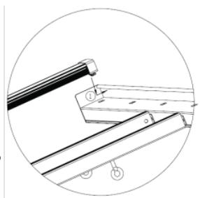
Assicurarsi che il driver sia stabile e capovolgere l'apparecchio in modo che il driver si trovi in posizione inferiore. Inserire l'estremità della barra luminosa con il gancio nel foro quadrato nel telaio A
