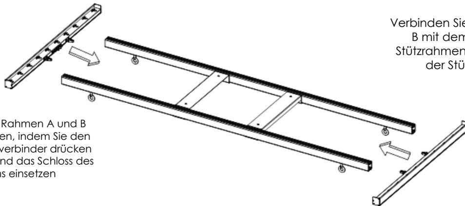
Verbinden Sie den Rahmen B mit dem Ende des Stützrahmens in der Nähe der Stützplatte.
