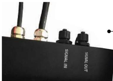
Schließen Sie das manuelle Dimmerkabel oder das Lichtsteuerungskabel an den SIGNAL IN-Anschluss an.
