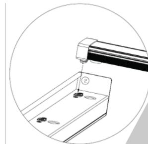
l'autre bout; alignez le trou rond du support B avec le bout magnétique de la lampe et insérez le pin mâle dans la fiche femelle. Assurez-vous que la liaison magnétique soit sécurisée.
