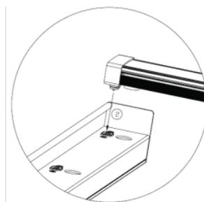
Poté vložte druhý konec; zarovnejte kulatý otvor na rámu B s magnetickým koncem světelné lišty a zasuňte konektor samce do zásuvky. Ujistěte se, že magnetické spojení je bezpečné.
