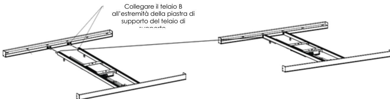
Collegare il telaio B all'estremità della piastra di supporto del telaio di supporto.
