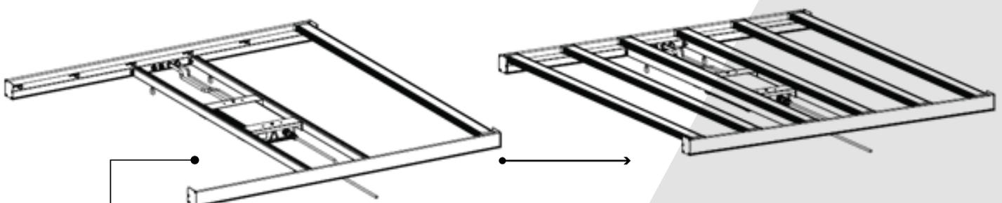
Montieren Sie die restlichen Lichtleisten wie in Abb. 9 gezeigt in den Halterahmen.
