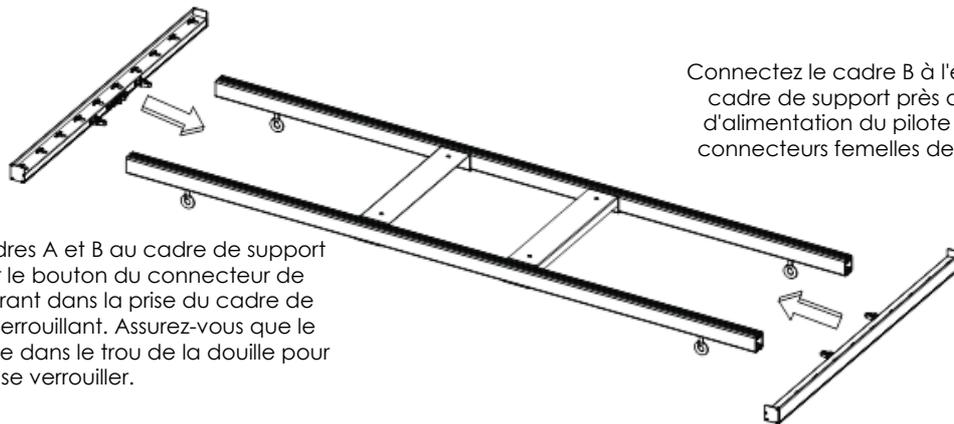
**Notez la direction lors de l'installation ; le support de montage du pilote LED est en haut lorsque le luminaire est suspendu.**
