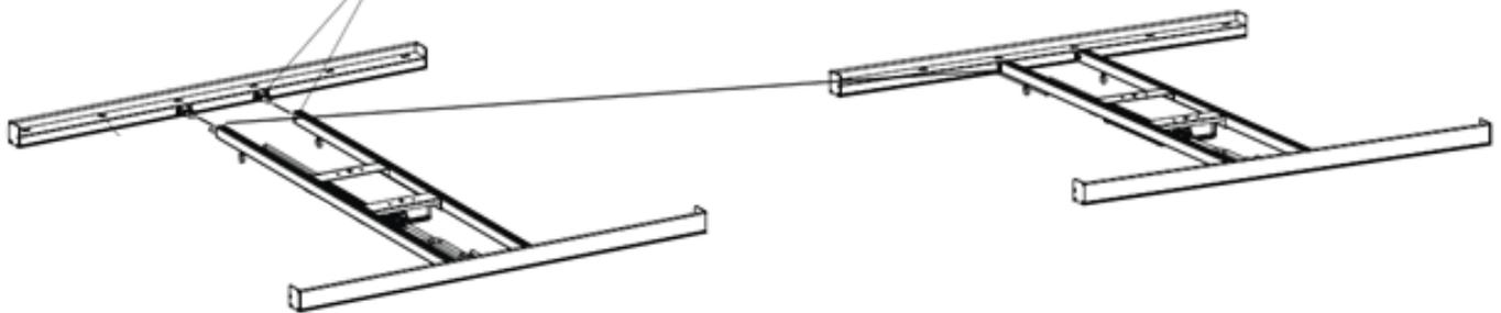
**Vérifiez sa direction lors de l'installation; le support du transformateur doit se trouver au-dessus lorsque la lampe est suspendue.**
